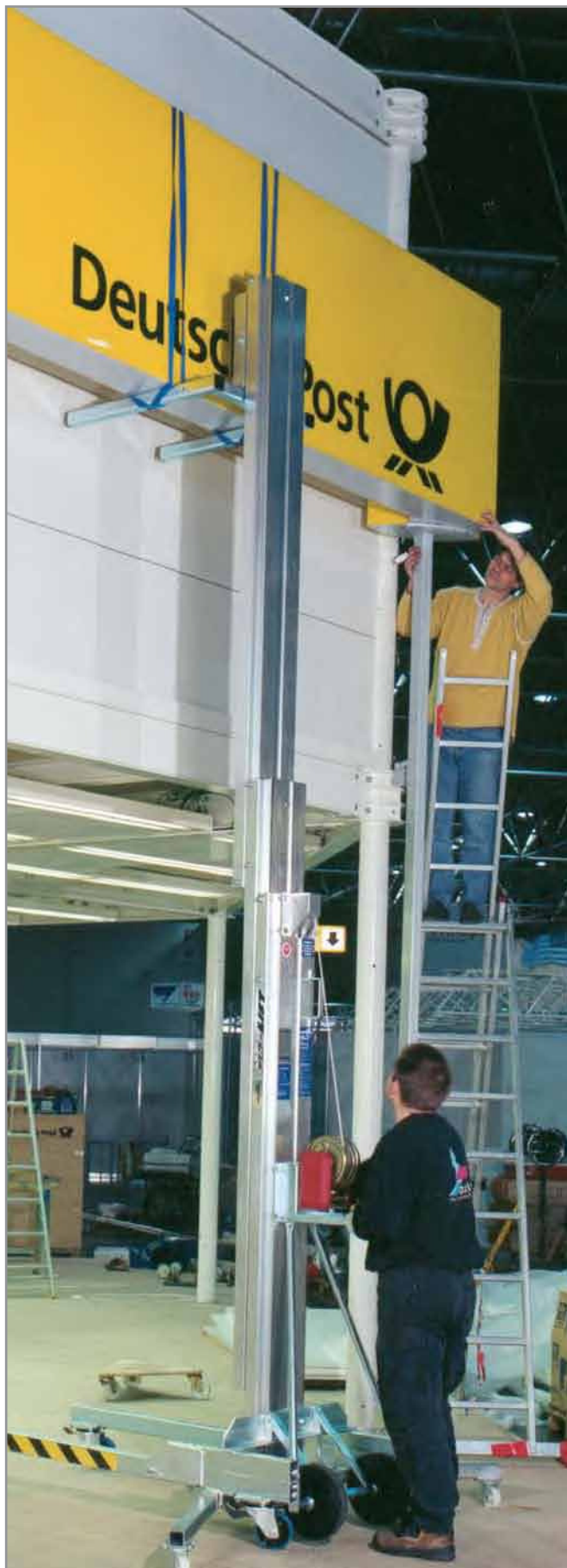
LM emelő kézi csörlővel, teherbírás 300 kg, emelési magasság max. 7,5 m
