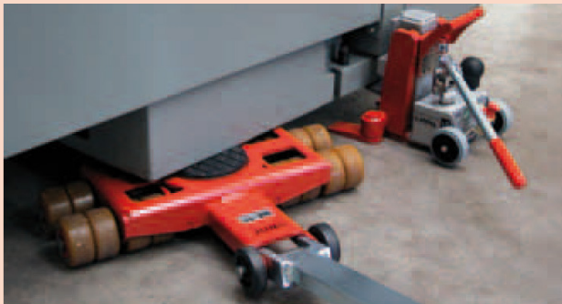
A golyóscsapágyozott görgők könnyű futást garantálnak
