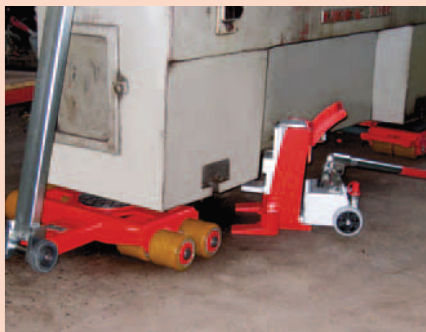
A JH 10 G plus használat közben K sorozatú önbeálló és görgős szállítószármal
