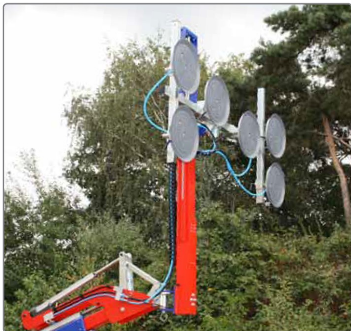
Elektromos teleszkóp hosszabbítás* majdnem az összes KS Robothoz, 250 kg teherbírásra korlátozva.
