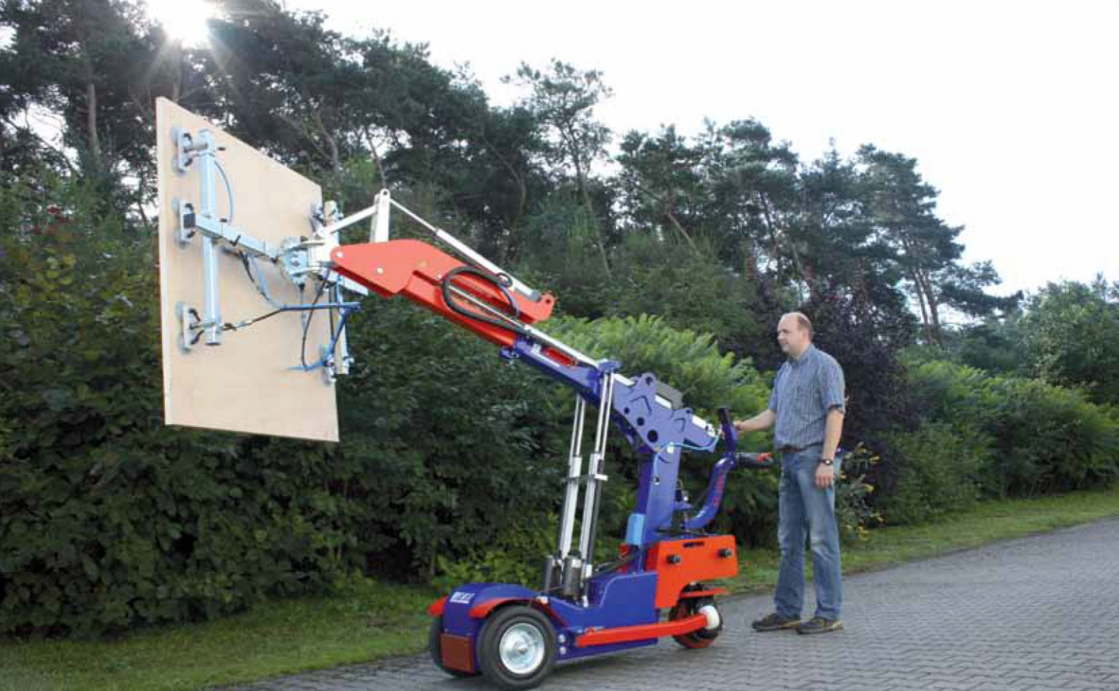
KS Robot 400 speciális vákuumos szívóegységgel falemezekhez.
