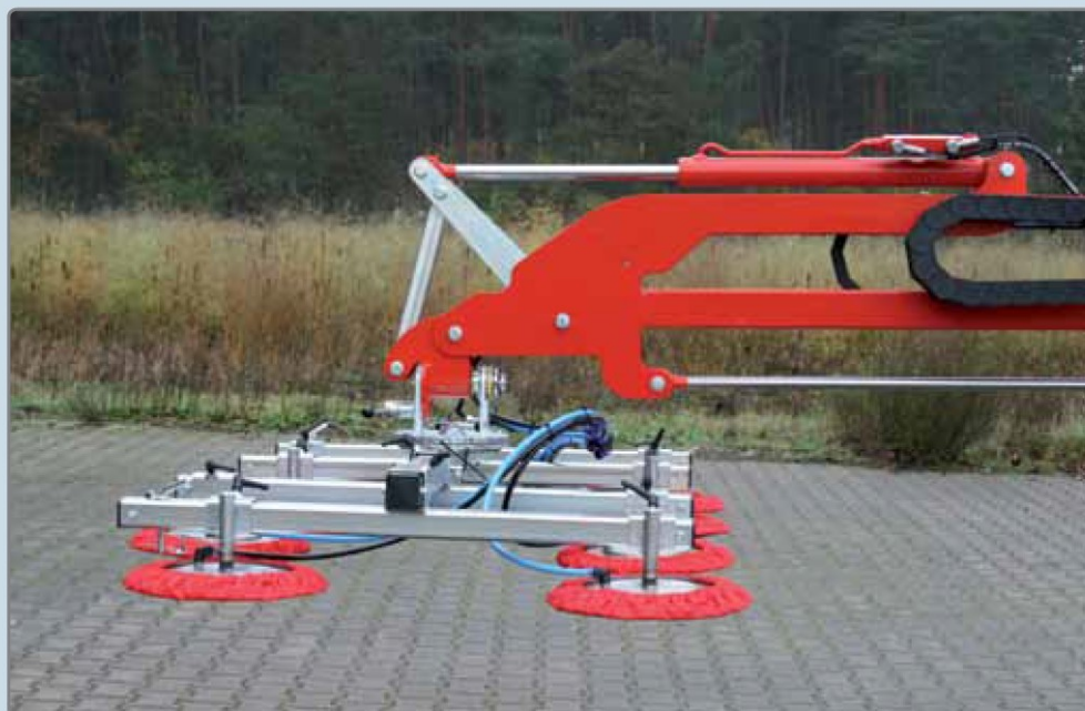
▲ Speciális forgó-billentő csukló a vízszintes helyzetből fej feletti pozícióba való elektromos billentéshez
