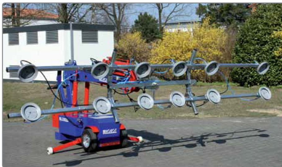
KS Robot 1000 vákuumos szívóegységgel hajlított üveghez*.
