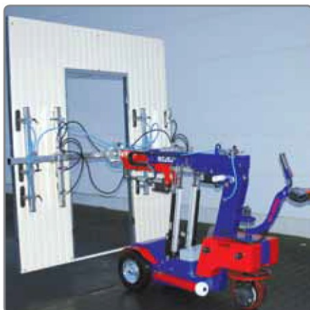
Ideális: vákuumos szívóegység keskeny szívófejekkel* trapézlemezekhez.
