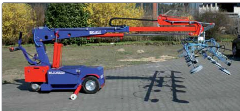
Sokoldalú: A szívótraverz hajlított* és sík üvegfelülethez egyaránt alkalmas.
