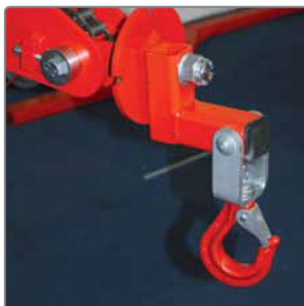
A teherhorog* másfajta, pl. emelőként történő használatot is lehetővé tesz.
