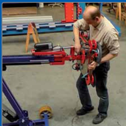
A vákuumegységet biztonsági okokból csavarral kell rögzíteni.
