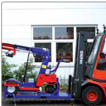
Nagyon praktikus: villástargonca foglalat* a felsőbb emeleteken végzett munkákhoz és a biztonságos szállításhoz.
