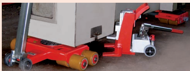
A golyóscsapágyazott görgők könnyű futást garantálnak Castors with ball bearings guarantee easy movement
