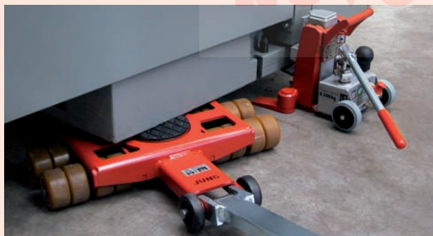
A golyóscsapágyozott görgők könnyű futást garantálnak Castors with ball bearings guarantee easy movement
