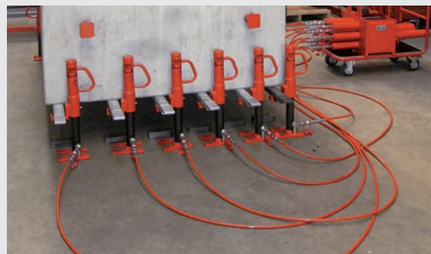
Speciális nyomóegység 12 emelőkészülékkel szinkronban való emeléshez. Customised solution pressure block for lifting with 12 jacks
